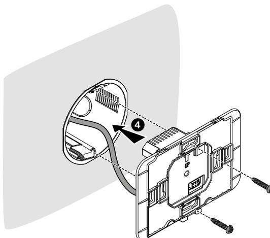
**Achtung:** Die Schrauben nicht übermäßig festziehen, um den Boden nicht zu verformen und die Installation der Vorrichtung zu beeinträchtigen.
