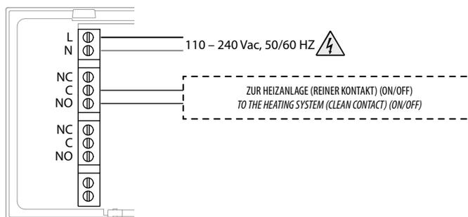
Anlage nur für Heizen mit durch die Netzspannung zu steuernde Stromlast (z.B. Magnetventil 230Vac oder andere Lasten, Kontaktleistung 5(2) A)
