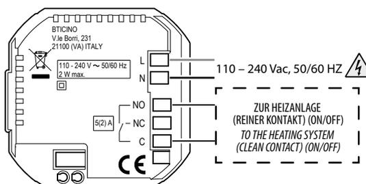
Anlage nur für Heizen mit durch die Netzspannung zu steuernde Stromlast (z.B. Magnetventil 230Vac oder andere Lasten, Kontaktleistung 5(2) A)
