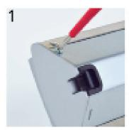
Gehäuse öffnen. Schraube auf Seite. des Kabeleinlass.
