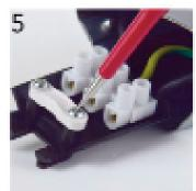
Zugentlastung lösen. Kabel anschliessen,
