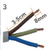
Anschlussleitung in Anschlussschema korrekter Länge vorbereiten.
