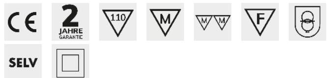
**Besonderheiten:** 12 V/DC LED Netzteil mit MM- und F Zeichen - ideal für direkte Montage auf normal entflammaren Oberflächen wie z.B. Holz. Geschützt gegen Überstrom, Kurzschluss, Übertemperatur Temperaturbereich: -20°C bis +50°C (tc=80°C) Kennzeichen: SELV, MM, F, Schutzklasse 2, IP20
